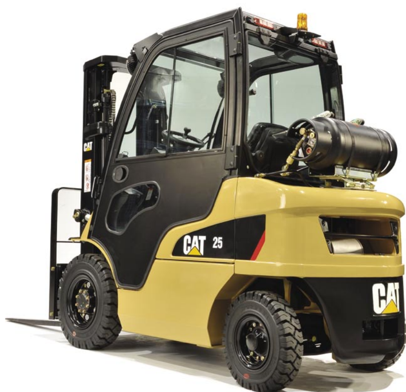
Cabina panelada con puertas de acero
