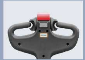
La función de gestión del timón vertical permite trabajar dentro de un espacio muy reducido, como puede ser un contenedor.
